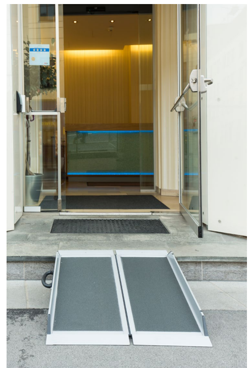
Eingang mit mobiler Rampe
